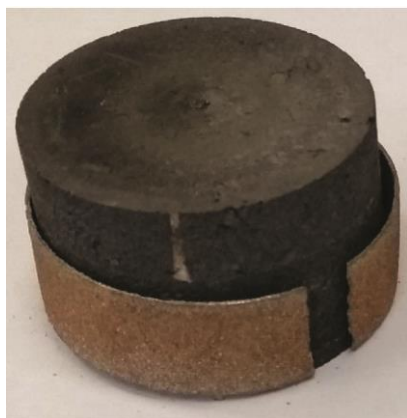
Рис. 9. Фотография образца с покрытием, разрушенным по адгезионному типу
