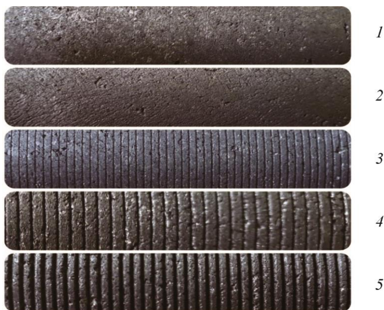
Рис. 2. Поверхность образцов графита после механической обработки: 1 – токарно-лезвийная обработка; 2 – крацевание; 3, 4, 5 – нарезка резьбы глубиной 0,25/ 0,5/ 1,0 мм соответственно
