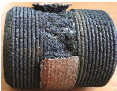
Рис. 13. Фотография образца с покрытием, разрушенным по телу графитового образца
