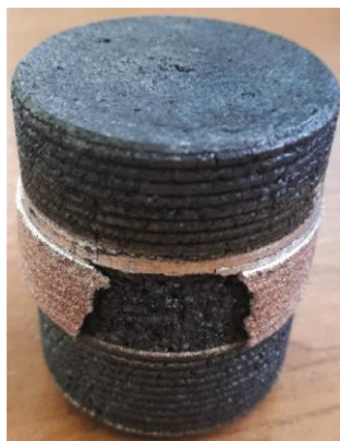
Рис. 11. Фотография образца с покрытием, разрушенным по когезионно-адгезионному типу
