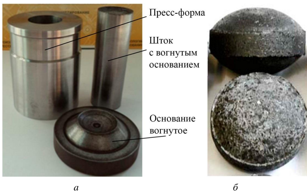
Рис. 1. Матрица для брикетирования (а) и форма получаемого брикета «подушка» (б)
