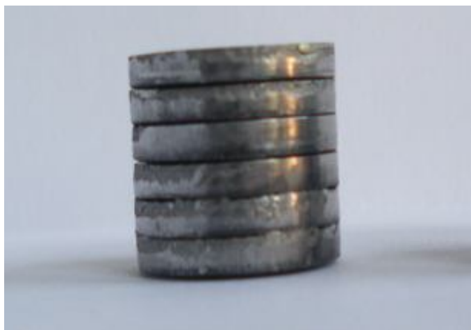
Рис. 11. Общий вид составного цилиндрического образца перед испытанием
