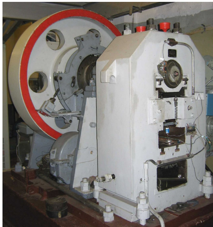
Рис. 2. Общий вид кулачкового пластометра ИМАШ УрО РАН
