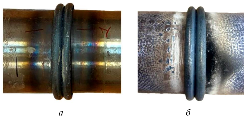
Рис. 4. Внешний вид биметаллической трубы после РСТ, реализованной по 1-му режиму (а) и 2-му режиму (б)
