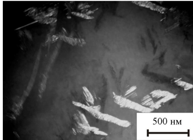
Рис. 7. Темнопольное (в пучке \bar{1}01_{\alpha} ) изображение \alpha -фазы в сплаве ТС6 после старения в рекристаллизованном состоянии по режиму: 480 °С, 20 ч
