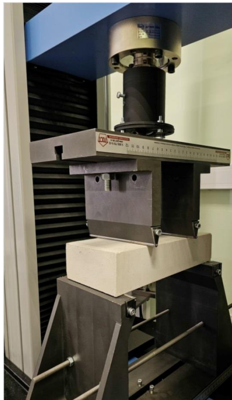
Рис. 2. Фотография испытания образца в виде прямоугольной балки на четырехточечный изгиб
