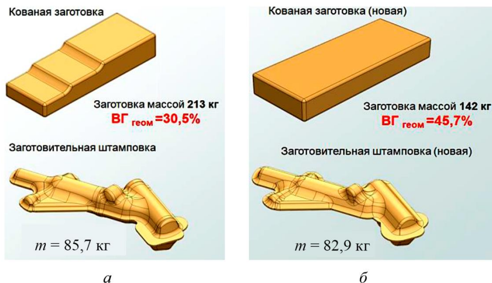
Рис. 3. Существующая технология штамповки стойки шасси (а); оптимизированная технология (оптимизация заготовки по форме и весу) (б)
