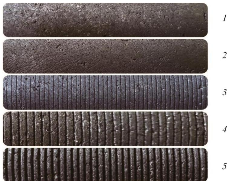
Рис. 2. Поверхность образцов графита после механической обработки: 1 – токарно-лезвийная обработка; 2 – крацевание; 3, 4, 5 – нарезка резьбы глубиной 0,25/ 0,5/ 1,0 мм соответственно
