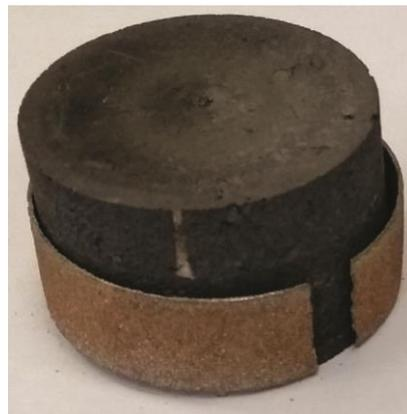
Рис. 9. Фотография образца с покрытием, разрушенным по адгезионному типу
