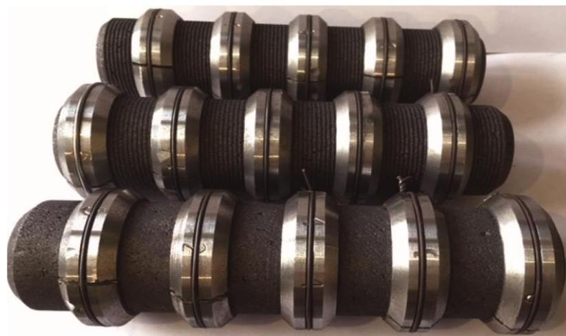
Рис. 3. Заготовки перед напылением порошковых материалов
