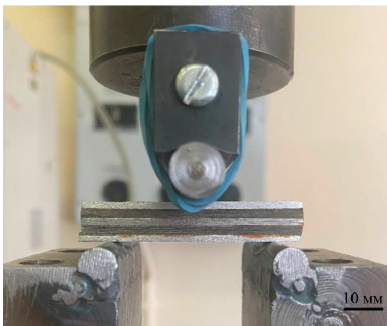
Рис. 1. Схема испытания композитов на знакопостоянный циклический изгиб
