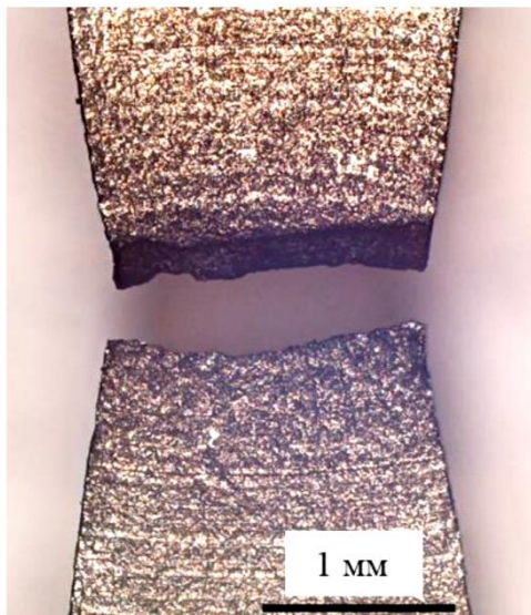
Рис. 13. Типичный вид разрыва в области шейки кольцевого образца после испытания на растяжение на полуцилиндрических опорах
