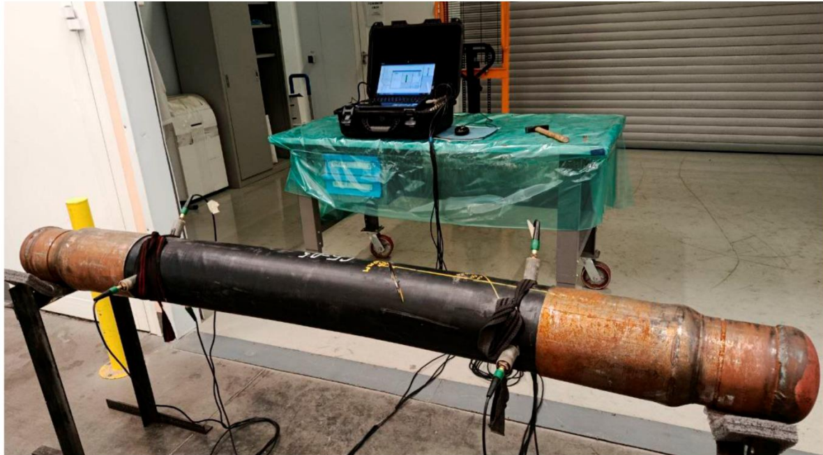
Рис. 3. Внешний вид образца с датчиками для детектирования волнового сигнала
