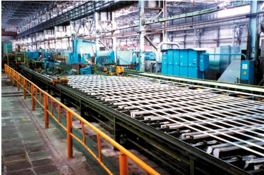
Рис. 9. Линия скоростного прессования, прессовый цех
