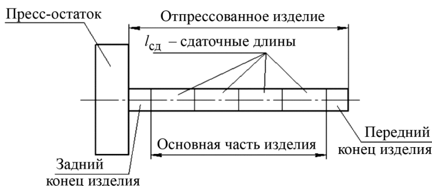
Рис. 1. Схема расположения частей прессованной заготовки [2]: передний конец изделия – выходной конец; задний конец изделия – утяжинная часть
