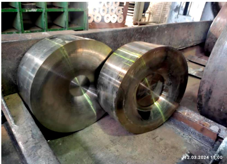
Рис. 5. Пресс-шайбы № 1 и № 2 перед загрузкой в печь нагрева инструмента
