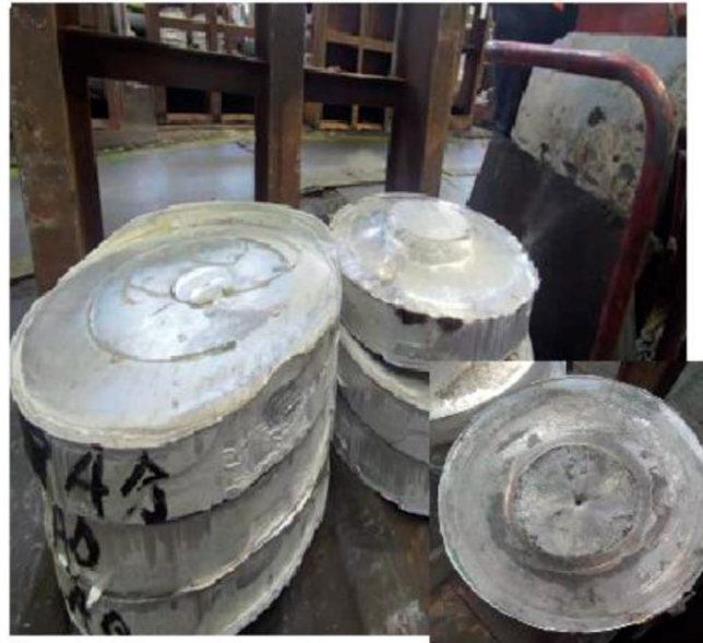
Рис. 8. Пресс-остатки с плоской пресс-шайбы и пресс-шайбы № 2, высота 60 мм
